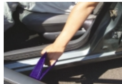
Figure 7 - Sangle de rappel de la portière avant côté conducteur.
