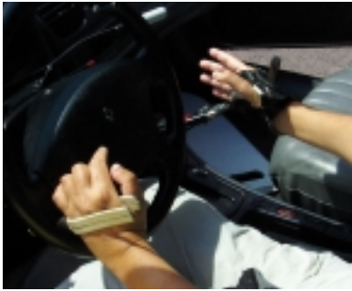
Figure 11 - Commandes de direction et combiné frein/accélérateur pour tétraplégique.
