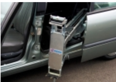
Figure 5 - Bras manipulateur d'embarquement.
